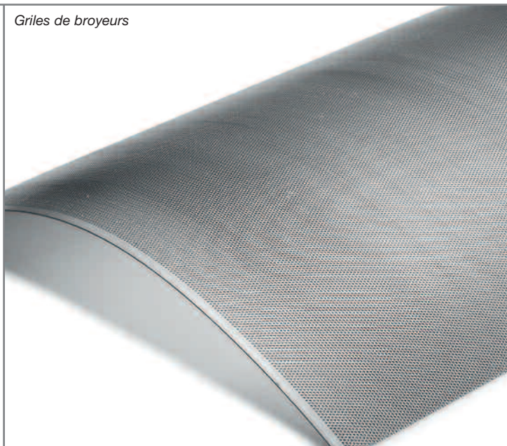
Trous ronds de 3 mm entraxe 4mm dans épaisseur 4 mm = 51% de vide
