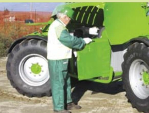
Le moteur peut être extrait de son logement en le pivotant sur un axe vertical.
