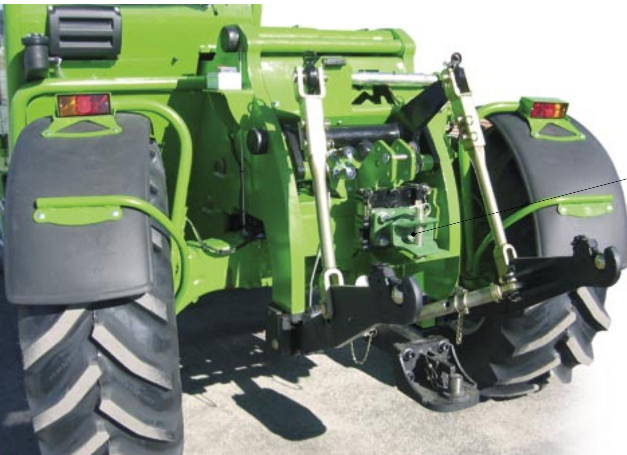
Le crochet multiposition permet l'attelage de remorques et d'équipements agricoles avec un P.T.R.A. de 27 tonnes.
