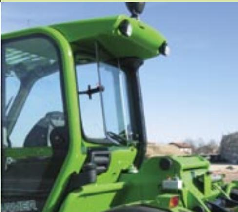
La grande surface vitrée de la cabine permet une visibilité réellement panoramique. Les vitres AV et AR peuvent s'ouvrir pour avoir une ventilation "naturelle".
