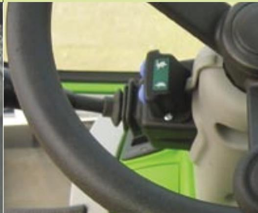
L'inverseur électro-hydraulique système "Finger-Touch" permet à l'opérateur d'inverser le sens de marche sans ôter les mains du volant.
