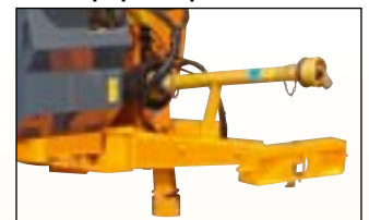
Attelage fixe avec flèche télescopique et pivotante
