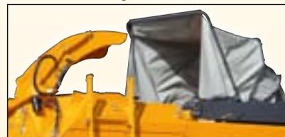
Un filet de mélange placé à l'arrière de la cuve assure un mélange aéré et appétent.
