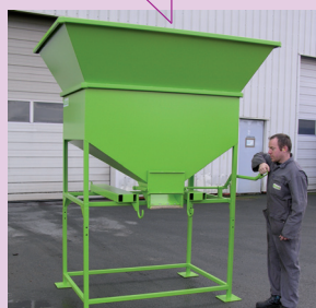
FG rehaussée avec accès levier en façade
